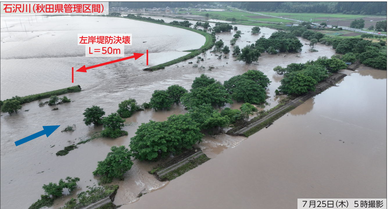
令和6年7月25日からの大雨により石沢川の堤防が決壊 写真提供：秋田県
